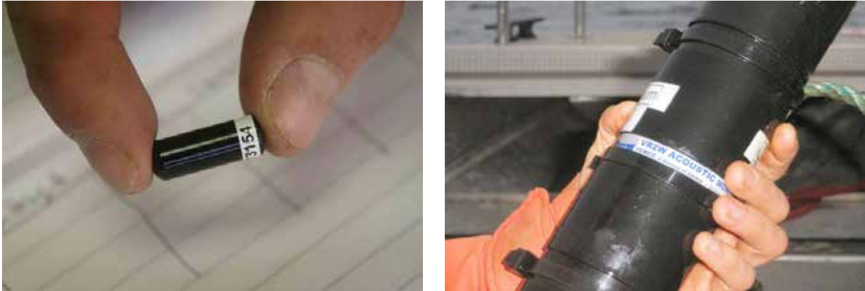
Figur 1. Akustisk sändare (V6 Vemco) och mottagare. Foto: Olle Persson och Johnny Norrgård
