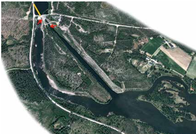
Figur 12. Oversikt over Lutufallet kraftverk og tilhørende vannveier. Røde piler angir fiskeinngangene til fisketrappa som samles i et felles løp i øvre del.
