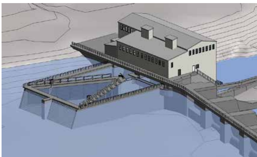
Figur 5. Principutformning av ett dubbelt \beta -galler för Edsforssens kraftverk. Illustration: Lind et al. (2014)
