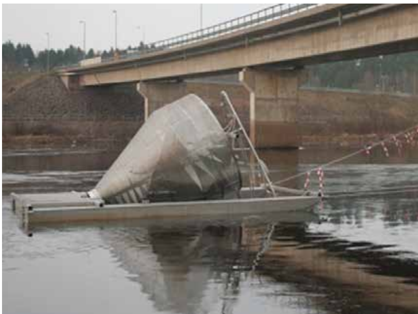
Figur 2. Roterande skruvfälla placerad vid Skårebron i Karlstad 2011.
