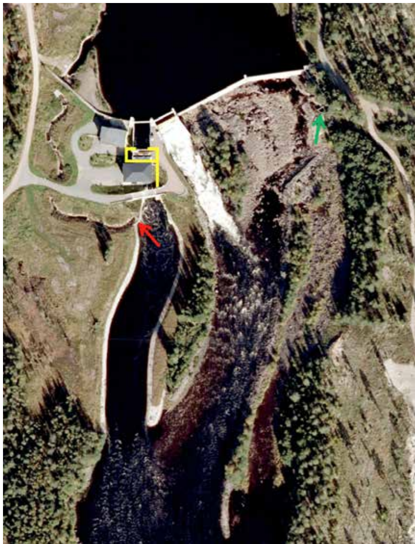
Figur 13. Prinsipp-skisse over Sagnfossen kraftverk og tilhørende vannveier. Forslag til plassering av to nedvandringsspassasjer ved turbininntaket er vist med gule linjer, Forslag til ekstra fiskeinngang til fisketrappa ved turbinutslaget er markert med rød pil, mens den gamle kulpetrappa er markert med grønn pil. Se tekst for nærmere forklaringer.
