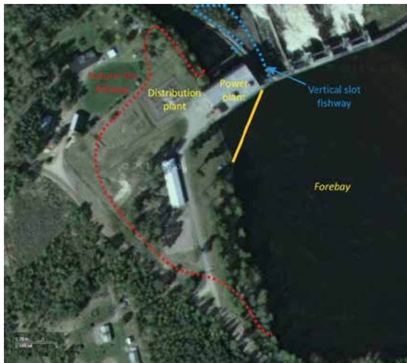
Figur 9. Prinsippskisse som viser forslag til plassering av to oppstrøms fiskepassasjer (rød og blå stiplet linje) og fiskeavleder (gul linje) ved Edsforsen kraftverk.
