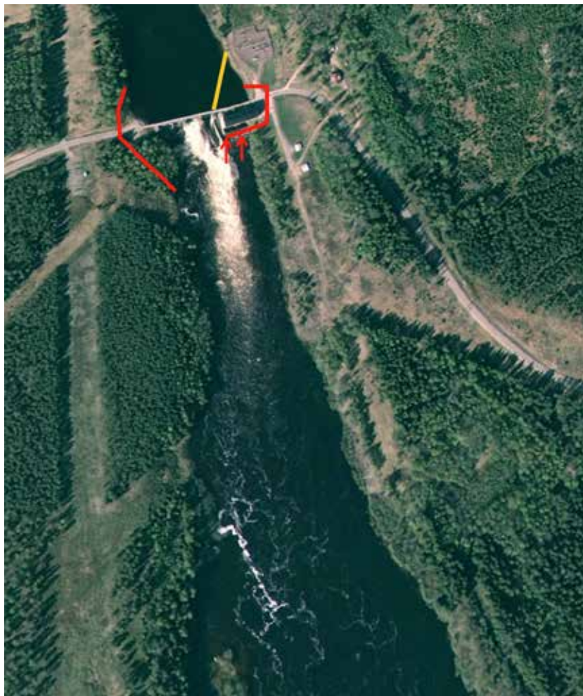
Figur 8. Prinsipp-skisse som viser forslag til plassering av to fisketrapper (røde linjer) og fiskeavleder (gul linje) ved Skoga kraftstasjon.
